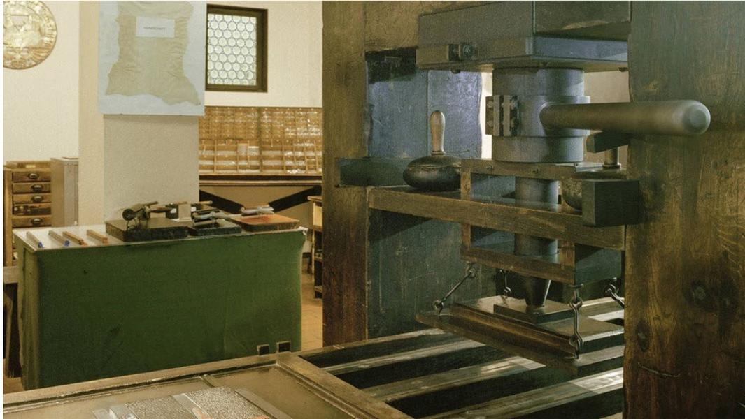
Eine Druckpresse ist eine mechanische Presse, mit der ein Bild oder Text mittels einer gefärbten Druckform auf einen Bedruckstoff übertragen wird, wodurch ein Abdruck entsteht.
